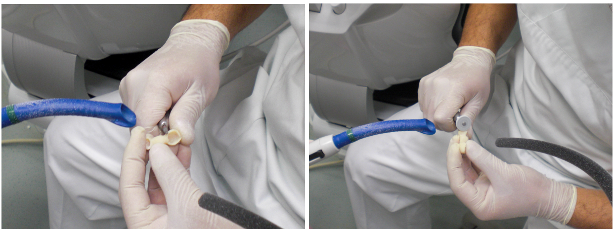
Abbildung 5.11: PMMA-Schleifen: links mit einem Diamantschleifkörper, rechts mit einer Trennscheibe
