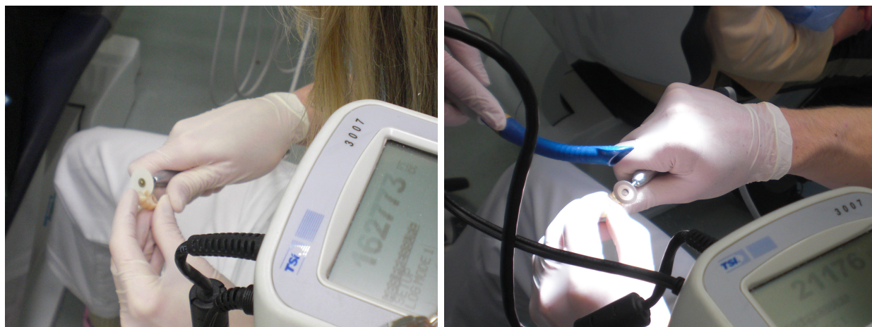
Abbildung 5.14: PMMA-Schleifen mit einer Trennscheibe ohne und mit Absaugung
