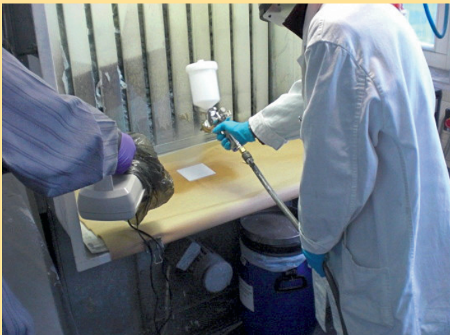
Abbildung 10: Spritzlackieren mit Böhmit-Lack unter dem Abzug. Figure 10: Spray painting with Böhmit-paint under the extractor hood.
